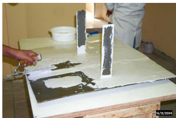
Foto n.º 2 - Aplicação da Camada Base
